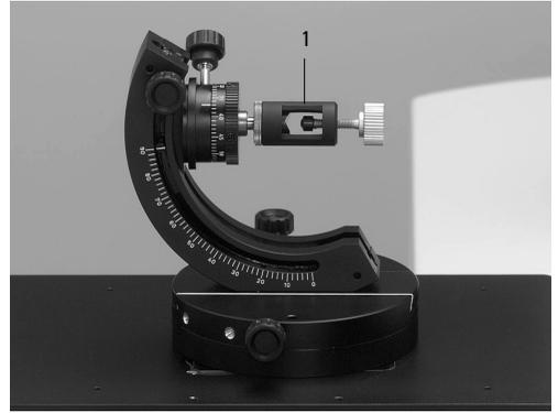
**Abb. 45** Verstellbarer Halter mit Aufnahme für Schließzylinder
