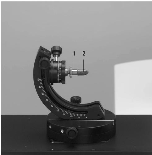
**Abb. 39** Verstellbarer Halter mit Aufnahme für deformierte Geschosse
