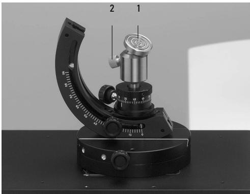
**Abb. 49** Verstellbarer Halter mit Gelenkhalter
